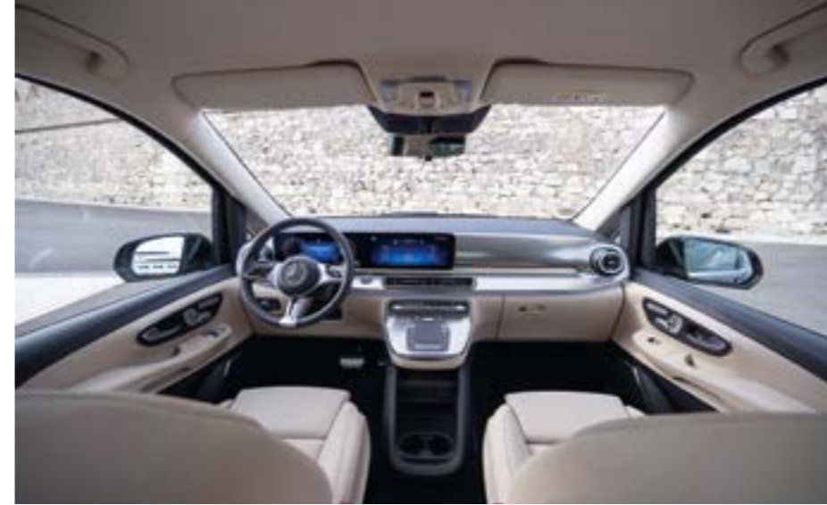
Die neu gestaltete Instrumententafel mit zwei 31,24 Zentimeter (12,3 Zoll) großen Displays in Widescreen-Optik und dem Infotainmentsystems MBUX.
